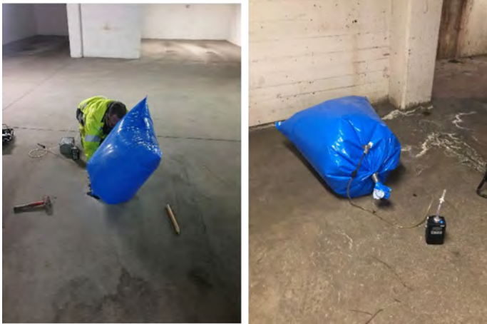
Figur 18. Provtagning av porgas (Garage_porgas1) utfördes genom att samla upp gasen, som direkt efter håltagning av plattan strömmade med ett högt tryck, i en sopsäck. Därefter utfördes pumpad provtagning över kolrör av gasen i säcken.
