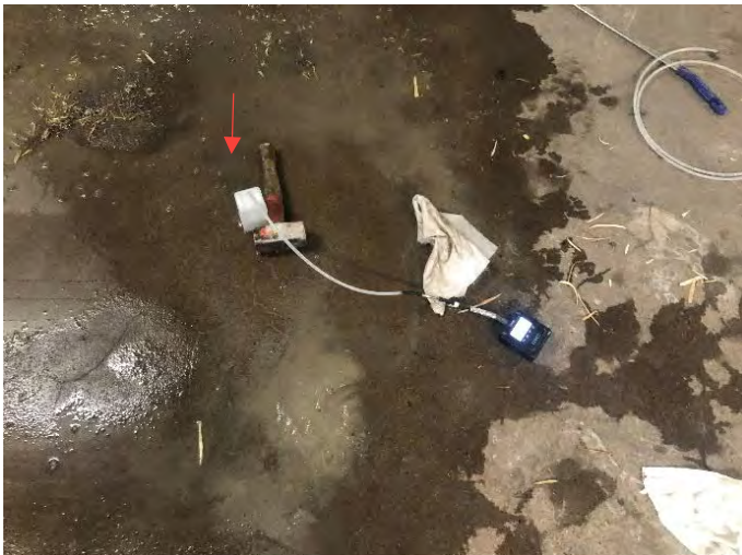
Figur 19. Två försök gjordes att "fånga" den uppströmmande gasen i en mindre plastburk vid borhålet för Garage. Iden fick dock överges då trycket på gasen och fukten från vattnet gjorde så att kolrören blev mättade av fukt.
