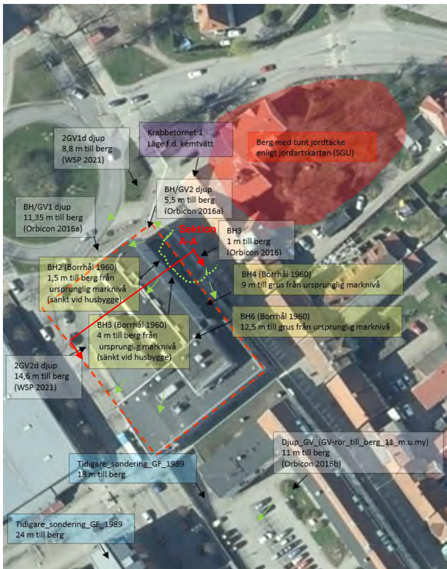
Figur 26. Djup ned till underliggande berg/ friktionsgrus utifrån borringar utförda i anslutning till Klocktornet 1, 34 och 37, fastigheter markerade med röd streckad linje. Grön streckad linje tolkad "bergsrygg" mitt för Klocktornet 1. Gröna pilar markerar tolkad lutningsriktning på bergets överyta. Röd heldragenlinje markerar geologiskt tvärsnitt för sektion A-A vilken redovisas i figur 27.
