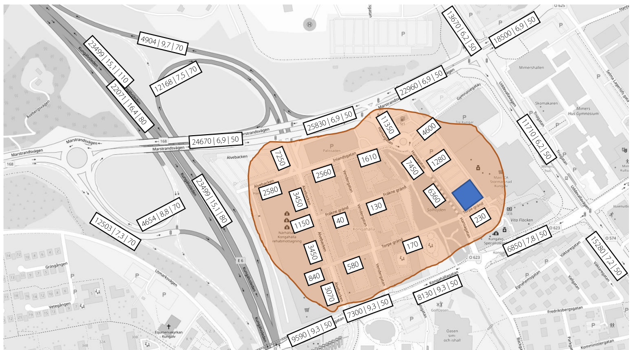
Figur 2. Redovisning av trafikdata som använts i beräkningsmodellen. Formatet är [ÅDT | % tung trafik | hastighet]. Redovisade värden inom orangea området har 5 % tung trafik, bortsett från Hansagatan som har 3 %. Hastigheten är 40 km/h, bortsett från Fräkne och Torpe gränd samt Alvebacken mellan Fräkne och Torpe gränd, där hastigheten är 30 km/h. Blå markering är Kvarter 7.
