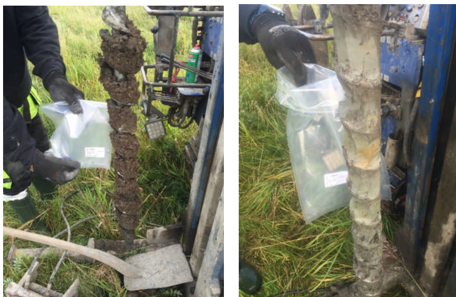
Figur 13. Skruvborrningsprovtagning. T.v. A2 0-1m, första metern i provtagningspunkten innehåller en del lera men även organiskt material och grövre jordarter. T.h. C5 1-2m, jordprovet domineras av lera med silt.
