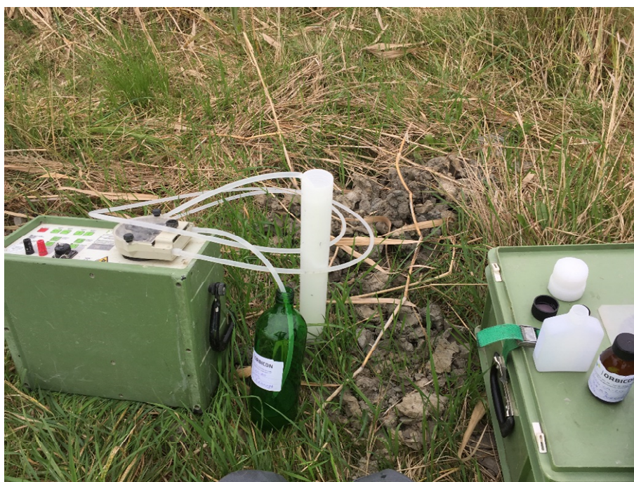
Figur 10. Grundvattenprovtagning med peristaltiskpump i grundvattenrör BA A3
