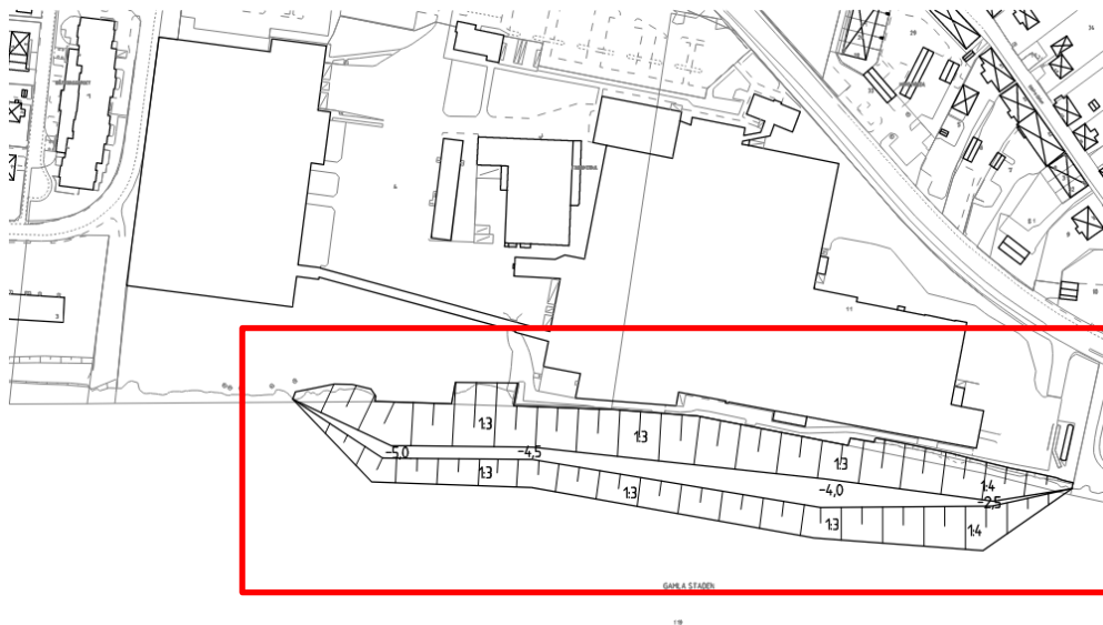
Figur 4, Tryckbank/Erosionskydd markerat med rött
