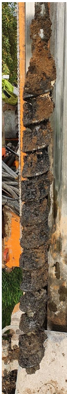
Figur 8 Fyllnadsmassor i punkt 21R04.
