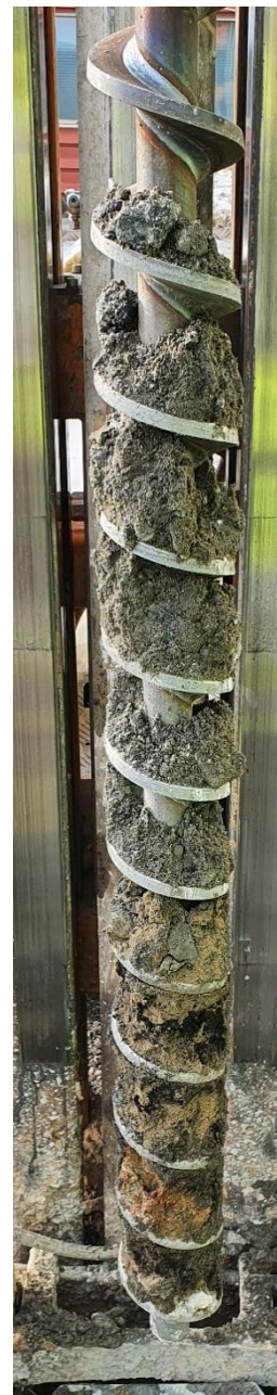
Figur 11 Fyllnadsmassor i punkt 21R110.
