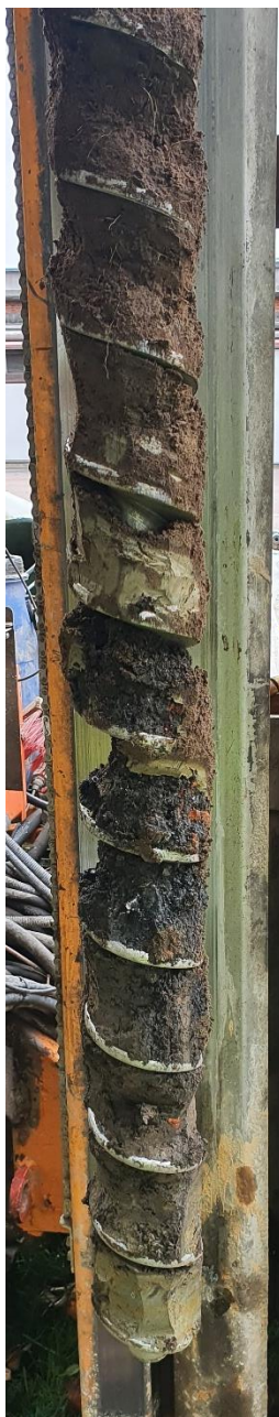
Figur 9 Fyllnadsmassor i punkt 21R11.
