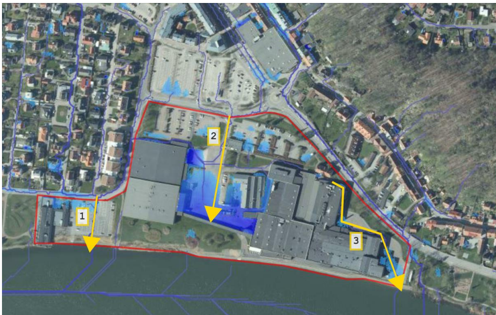
Figur 13. Blå områden visar stående vatten vid ett skyfall med återkomsttid 100 år. Gula pilar visar flödesvägar i befintlig miljö vid skyfall.
