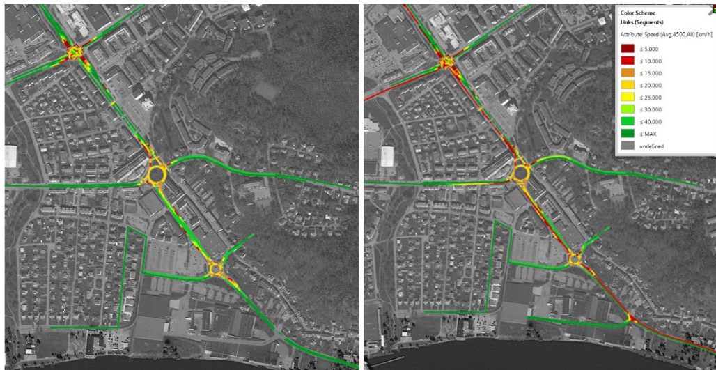
Figur 11. Framkomlighet Maxtimme eftermiddag, nuläge (tv) och 2040 (th). Se bilaga för större bilder.
