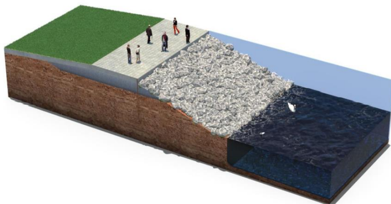
Figur 34. Slänt ned i vattnet med påbyggnad av vall med GC-väg på krönet (Översvämningsskydd längs Göta älv, 2014, Ramboll).
