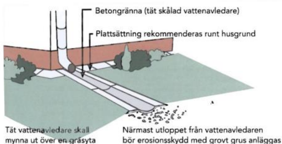
Figur 23. Principbild på stuprörsutkastare (Svenskt vatten P105, 2011)
