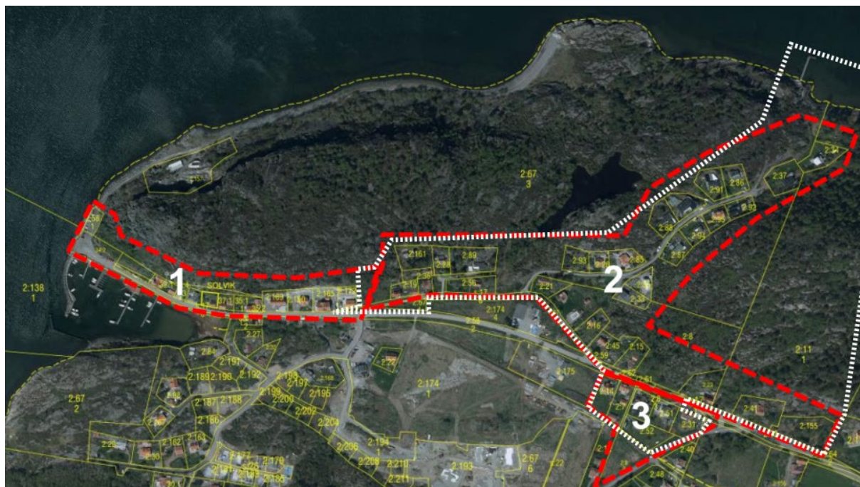
Figur 16. Delområden i den geotekniska undersökningen markerade med röstreckade linjer. Ungefärligt planområde markerat med vitstreckad linje.
