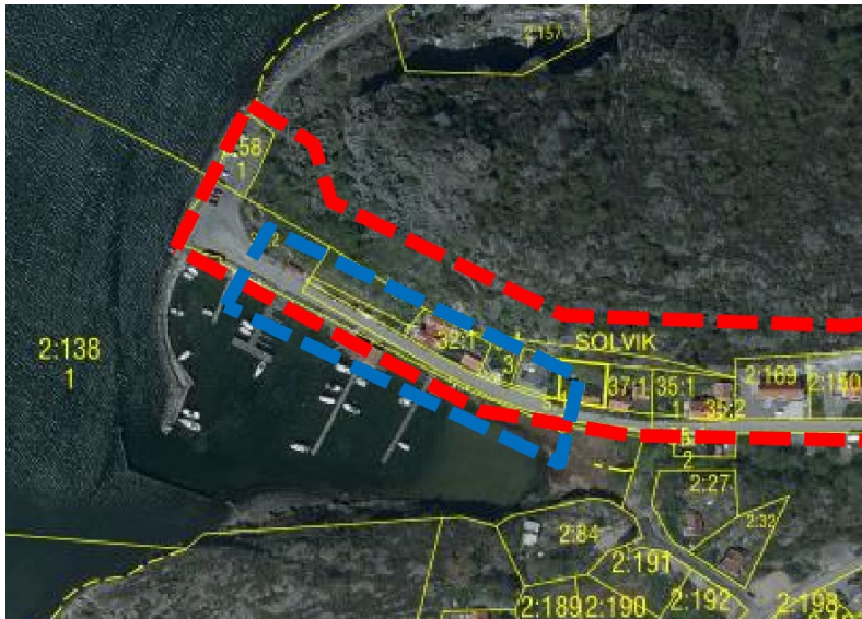
Figur 17. I området markerat med blåstreckad linje har otillfredställande stabilitet identifierats.
