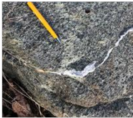
Figur 4. Bergarten är en gabbro/diorit med massformig struktur och med kvartsgångar.
