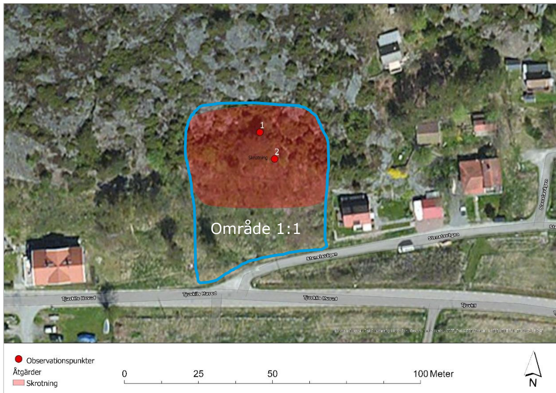
Figur 3. Område 1:1 är inringat i blått och observationspunkter visas i rött. Område där skrotning rekommenderas är markerat i rött.
