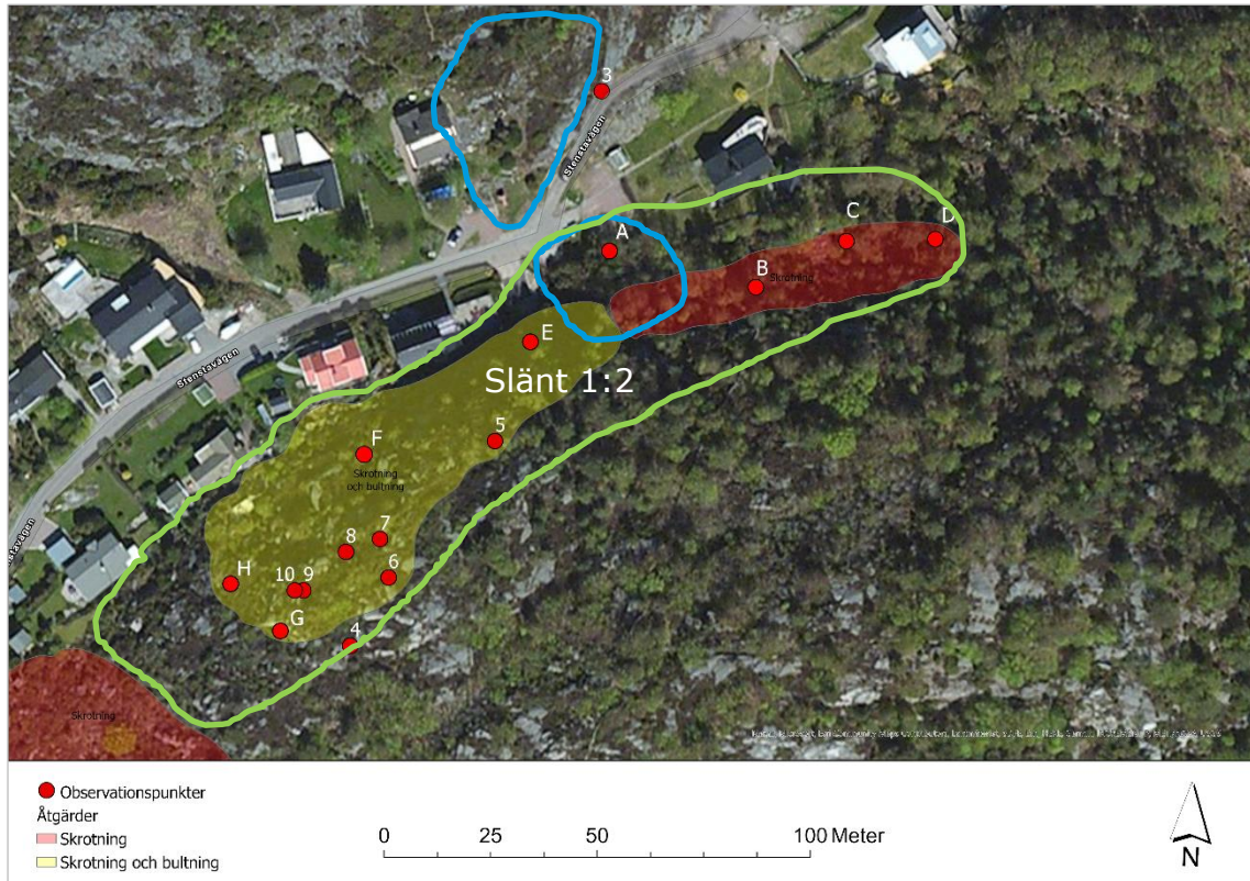
Figur 6. Område 1:2 är inringat i grönt och observationspunkter visas i rött. Områden där skrotning rekommenderas är markerat i rött, och där skrotning och bultning rekommenderas är markerat i gult.
