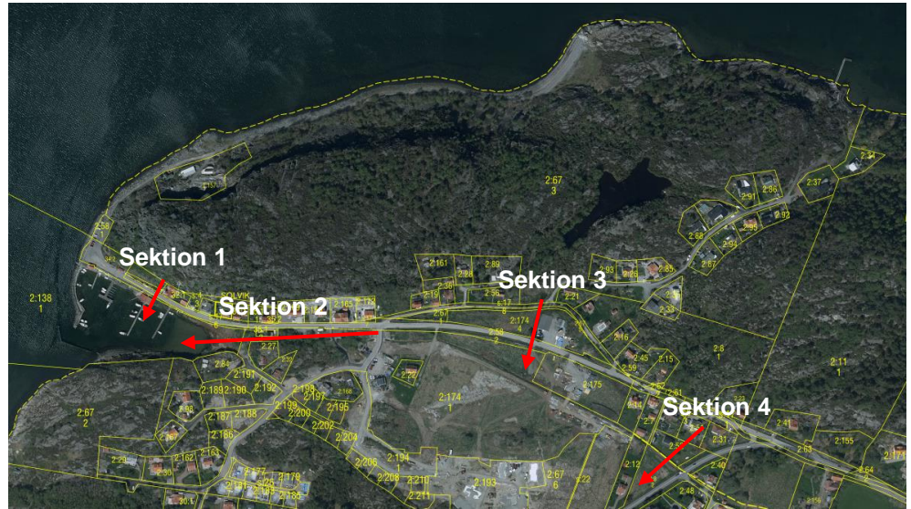
Figur 14. Skiss med utförda stabilitetssektioner.
