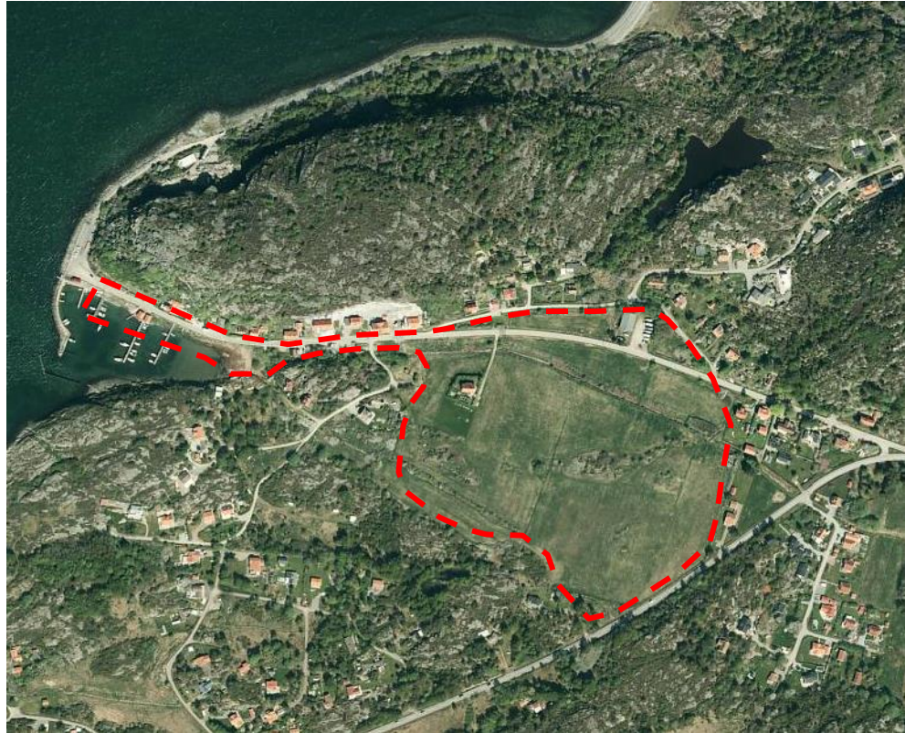
Figur 13. Del av planritning där en översiktlig bedömning av kvicklerans utbredning markerat med röd-streckad-linje.
