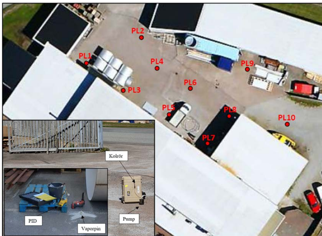
Figur 2. Mät- och provtagningspunkter för porgas/markluft på planen framför industribyggnaden. Infällt provtagning av porluft med kolrör för kemisk analys.
