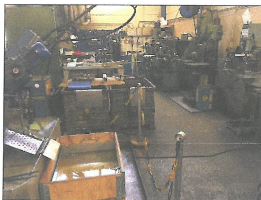
Figur 5. Den äldre delen av verkstadslokalen där golvytorna delvis kontaminerats av skärvätskor efter mer än 40 års verksamhet.
