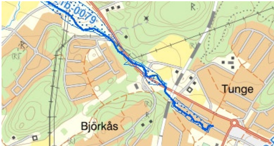
Bild 10 Prickat område utgör fastställt båtnadsområde och blå linje utgör Ytterbybäcken. Öster om järnvägen är bäcken kulverterad.
