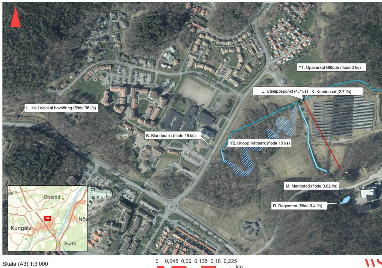
Figur 2. Utsläppspunkter och blandpunkter för bedömning av miljöbelastning i Komarksbäcken. Flöden efter utbyggnad av värmeverket.
