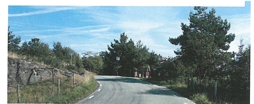
Bild 7: Då det saknas gångväg utmed vägarna placeras busshållplatserna många gånger vid fastighetsutfarterna, vilket som i det här fallet kan bli i en kurva med dålig sikt.
