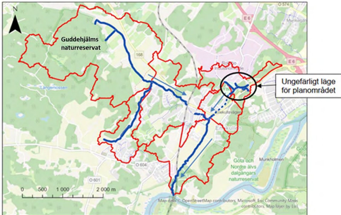
Figur 5 Översikt över Kyrkebäckens grenar (blå linjer) befintliga delavrinningsområden (röd avgränsning i planområdets närområde Källa: Skyfallsutredning Rollsbo, arenaområdet vid Yttern, 2022.
