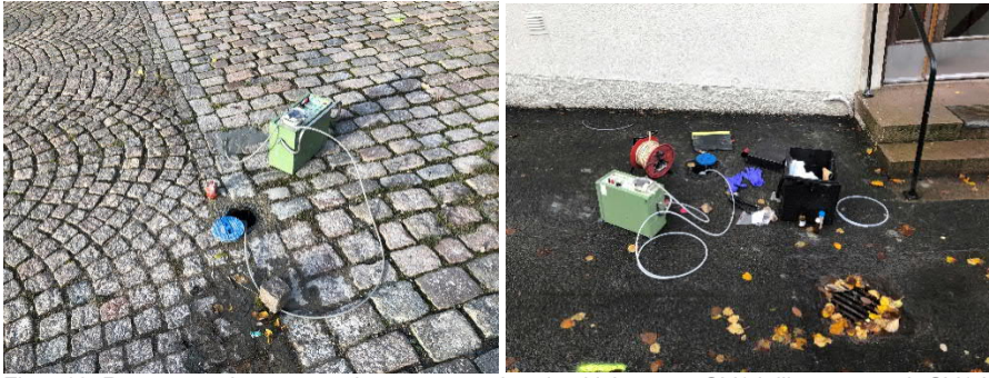
Figur 10. Renspumpning av grundvattenrör med peristaltisk pump. GV1d till vänster och GV1d till höger.
