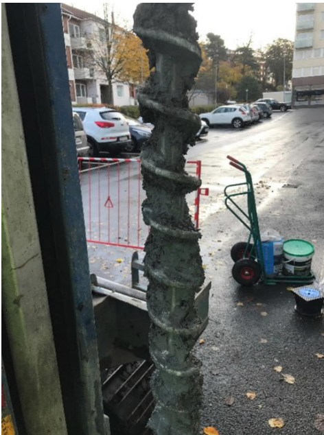
Figur 9. Skruvborring av provtagningspunkt GV1. Provtagnings av siltig lera 2,5-3,0m.
