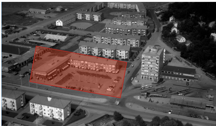
Figur 6. Flygfoto från 1960 över Nytorget. A= Ett antal tankar var tidigare nedgrävda där tankbilen står, tankarna var under trottoaren. B= Två streck syns i bakkant på bussen, detta är järnvägsspår fram till den tidigare tågstationen. C= De svarta fläckarna där bussarna står är olja + diesel läckage från bussarna.
