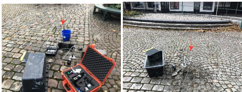
Figur 13. Pumpad gasprovtagning över kolrör med SKC-5000. Kontroll av flödet med rotameter. Provtagningspjut för provpunkt GAS4 till höger och GAS3 till vänster.
