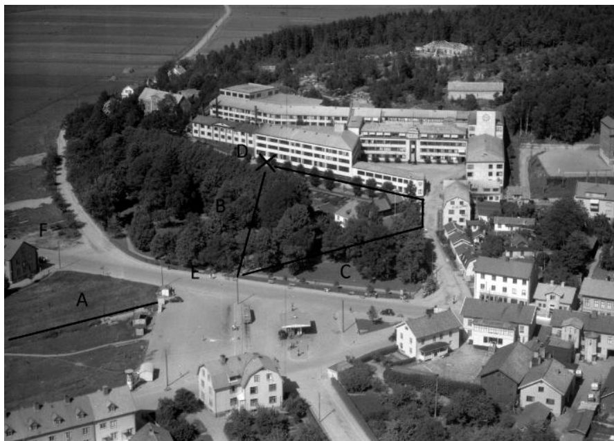
Figur 7. Flygfoto från ca 1948. A = öppet dike som kom från Västra Parken. B = Långt innan ABC-fabriken byggdes gick det ett öppet dike genom parken från en tidigare marknadsplats för kreatur. Om man lade diket i rör eller drog det vid sträckning C är okänt, troligen så har man dragit igenom kyrkogården då det är kortaste vägen. D= Här låg förnicklingsverkstaden med syrabad. E= Befintligt hål i häcken är lika med nuvarande övergångsställe mellan Stadshuset o Parken på metern exakt. F= Plats för den första bensinstationen på busstationen.
