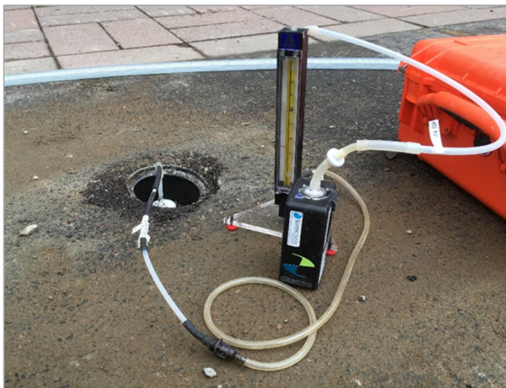
Figur 13. Pumpad gasprovtagning över kolrör med SKC-5000. Kontroll av flödet med rotameter.
