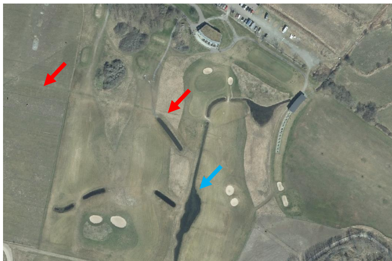
Bild 27. Dagvatten från norra planområdet leds via kulvert till golfbana. (Röd pil visar vart kulvert är belägen. Blå pil visar öppet dagvattendike/damm.
