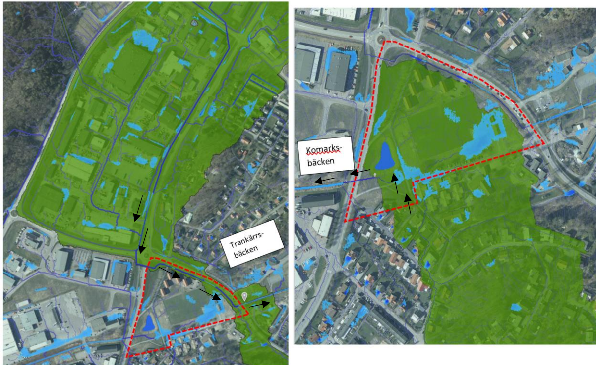
Figur 7. Till vänster modifierad SCALGO karta som visar ytvattens avrinningsområde för utloppet till Trankärrsbäcken och till höger modifierad SCALGO karta som visar ytvattens avrinningsområde för utloppet till Komarksbäcken (Källa: Kungälv kommun). Undersökningsområdet markerat med röd streckad färg i båda kartorna och ytvattenriktning är markerad i svart/pil.
