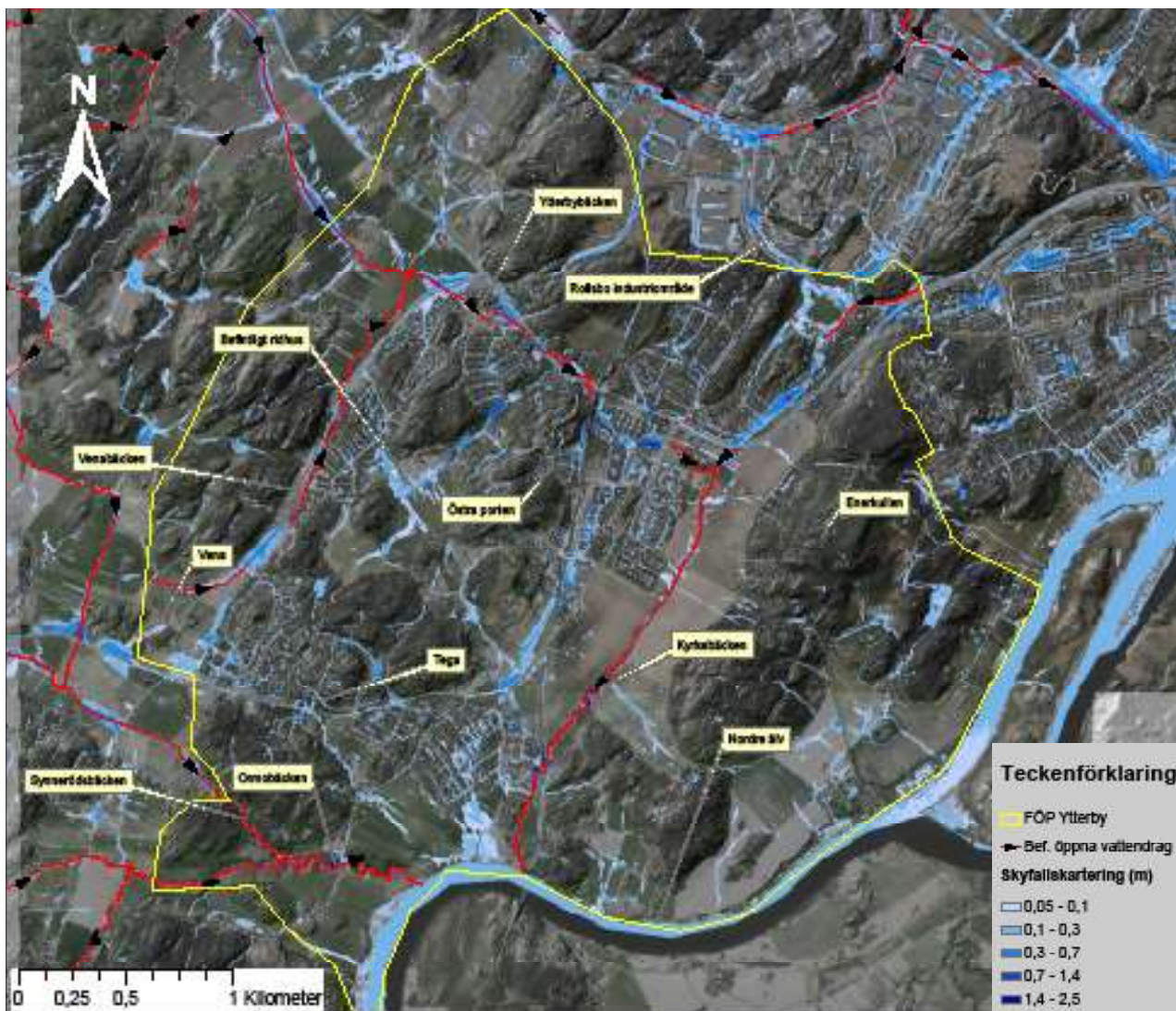
Bild 26. Skyfallskartering inom FÖP Ytterby (Karta från Översiktlig dagvattenutredning till Grönstrukturplan. FÖP Ytterby, Norconsult 2018)
