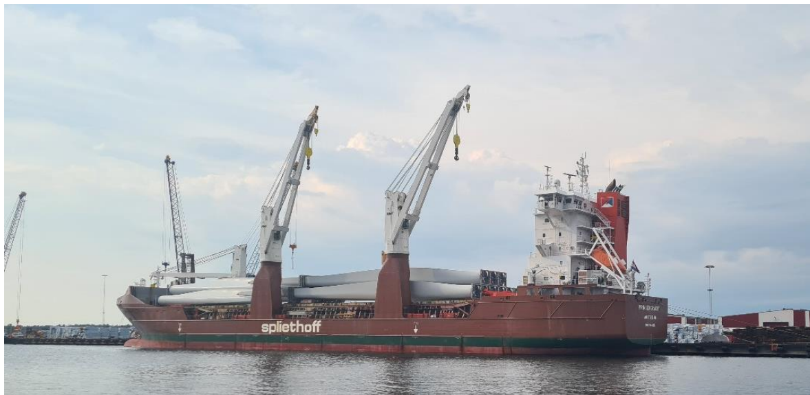
Figur 13. Fartyg lastat med rotorblad till vindkraftverk. Foto: Marine Monitoring AB.
