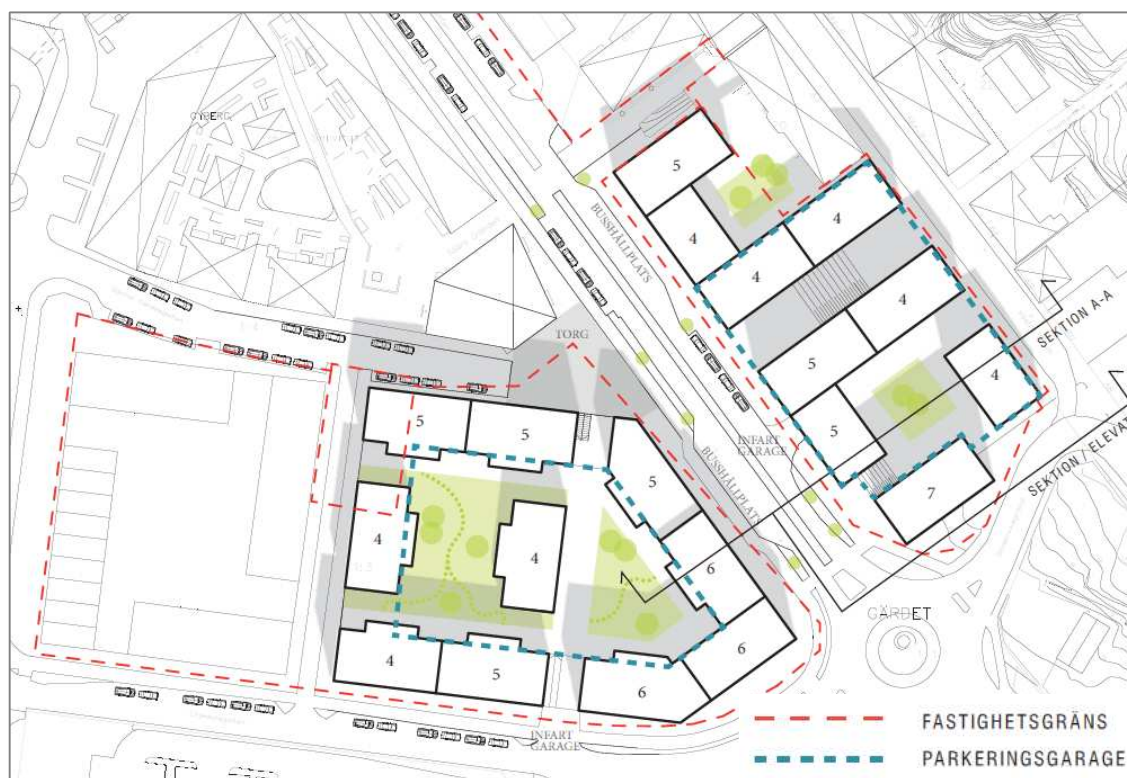
Figur 5. Förslag till lokalisering av källare med parkeringsgarage inom undersökningsområdet markerad med blå streckad linje (Kungälv kommun 2015).
