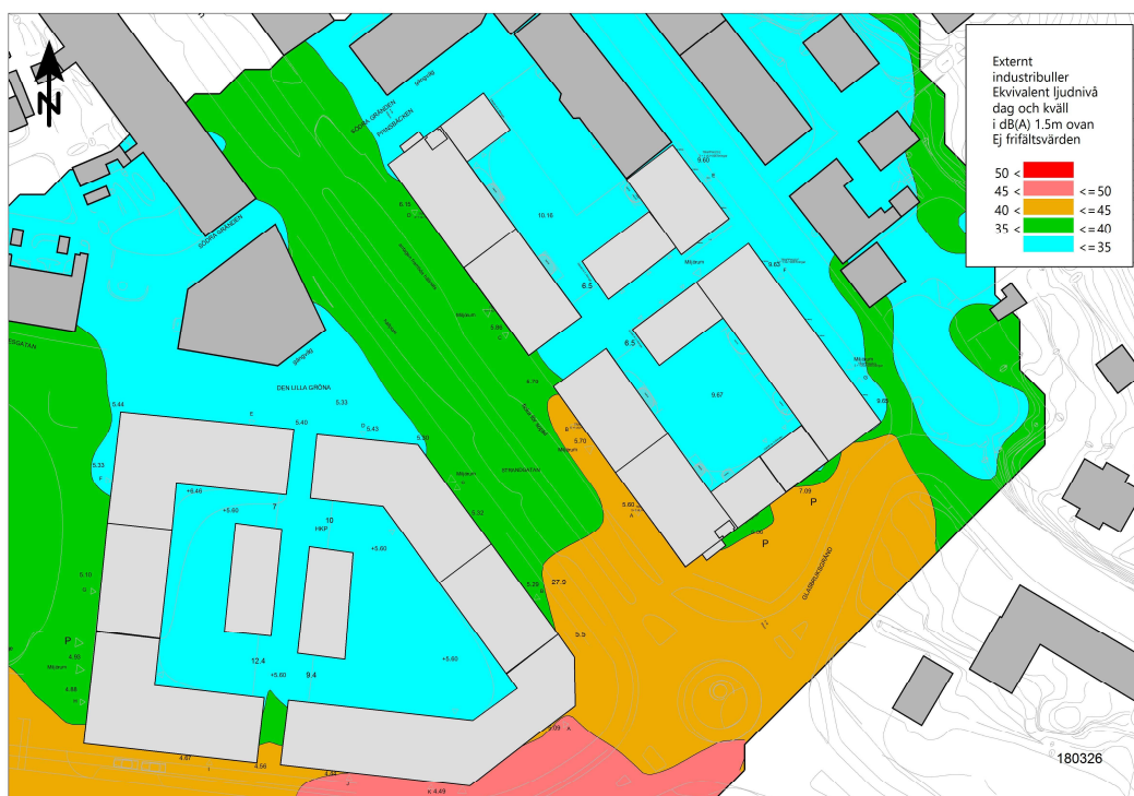
Figur 23. Externt industribuller från Göteborgs Kex. Ekvivalent ljudnivå under Dag och Kväll 1.5m ovan mark. Ej frifältsvärden. Grön och blå färg uppfyller Zon A (och även ljuddämpad sida enligt Zon B).
