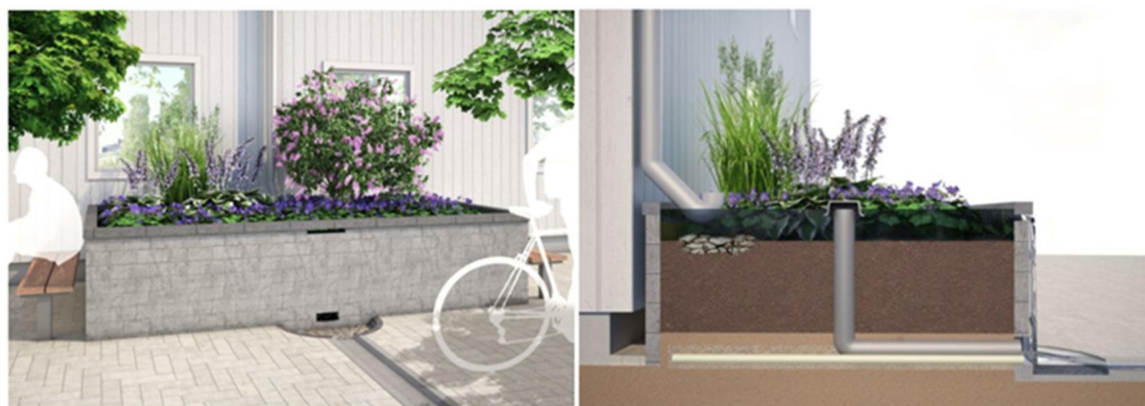
Figur 7. Illustration biofilter på mark.
