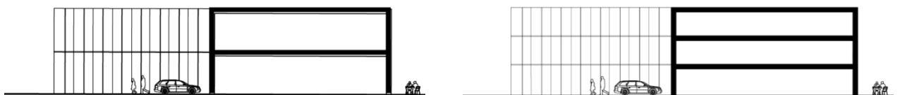
Sektion. Exempel på hur planens angivna byggnadshöjd på 10,0 meter för byggnaderna norr om Hollandsgatan möjliggör för byggnader i två eller tre våningar. (KAKA Arkitekter)
