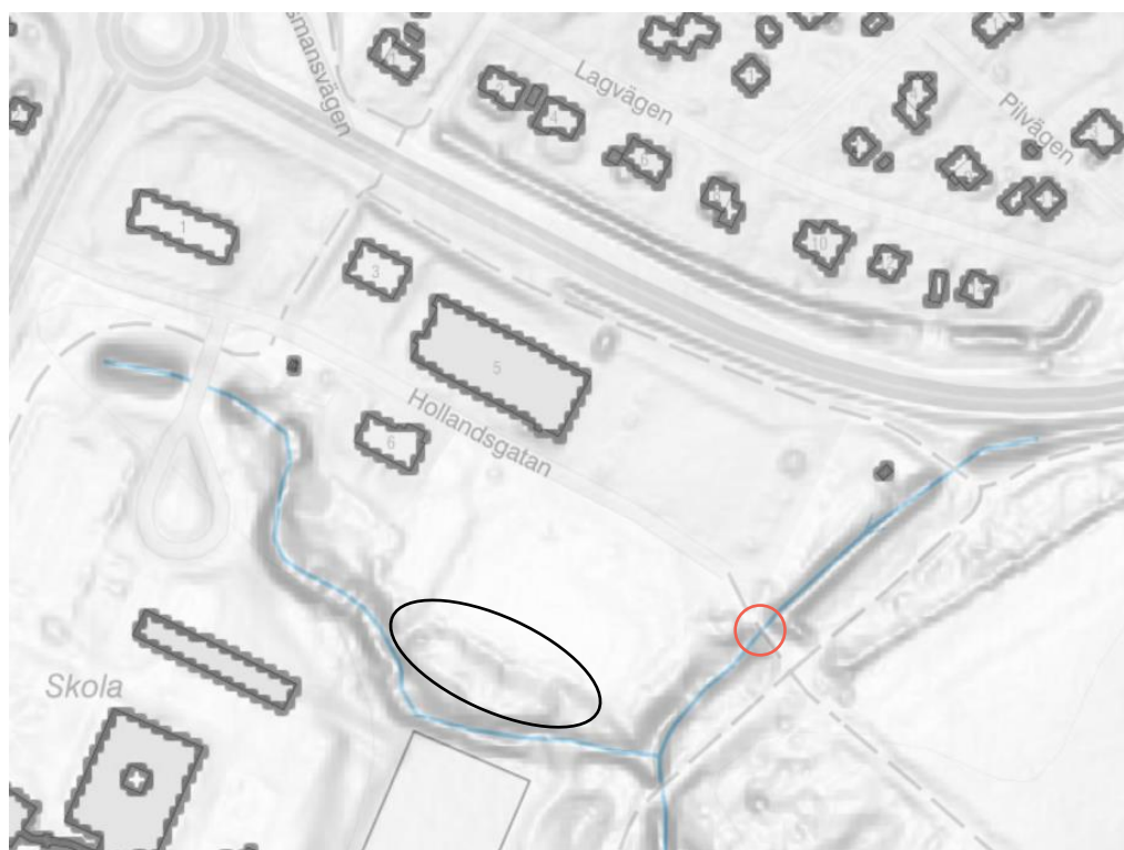
Figur 4. Topografisk karta överlagrad med terrängskuggning. Svackdike markeras med svart ring och bro i östra bäcken med röd ring.
