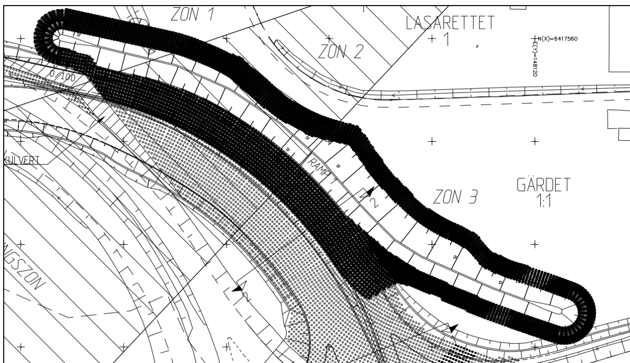
Figur 8-5 – Planritning över förstärkningsåtgärder (KC) intill diket (Trafikverket, 2016).
