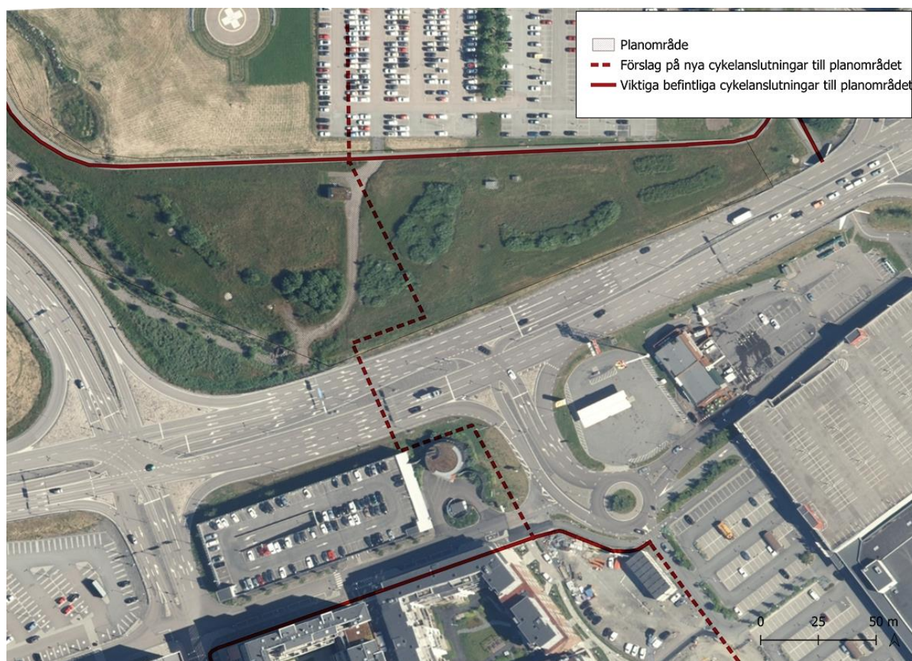
Figur 44. Schablonmässig idé över hur ramper skulle kunna anläggas i vinkel mot Marstrandsvägen för att komma upp i rätt höjd. Genomförbarhet och risk har inte utretts i detta skede. Bakgrundskarta: Lantmäteriet.
