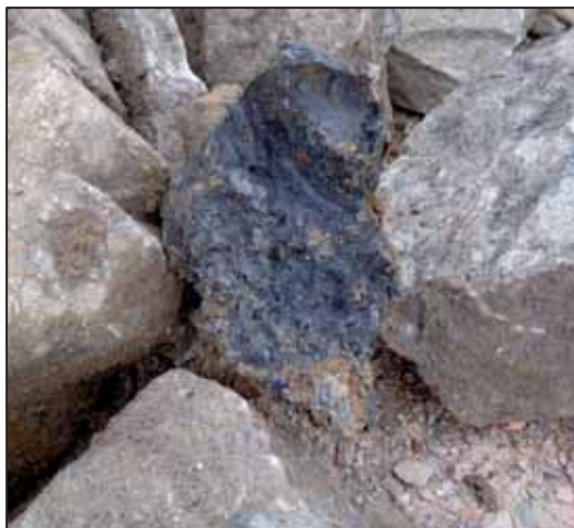
Figur 7 Bitar av asfalt i fyllning vid PG6
