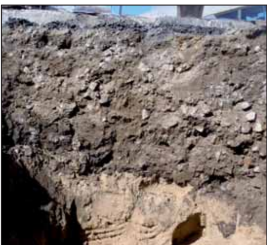
Figur 5 Ett lager homogen sand vid PG8
