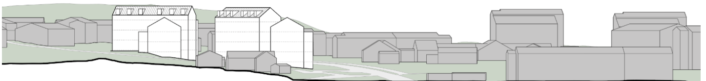
Bild 36. Volymstudie, området sett från öster. Illustrationen visar höjdförhållandena mellan föreslagen ny bebyggelse (vita byggnader) och kringliggande bebyggelse i söder, norr och öster (grå byggnader). Närmast angränsande bebyggelse direkt öster om planområdet ses framför de vita byggnaderna i bilden. Vita byggnader är exempel på en maximal exploatering utifrån plankartans regleringar.
