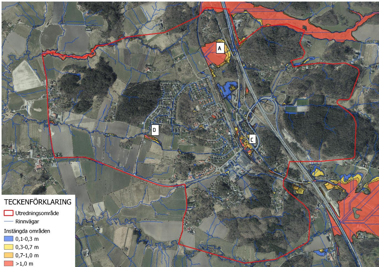
Figur 13. Lågpunktkartering (bild från WSP med justeringar).
