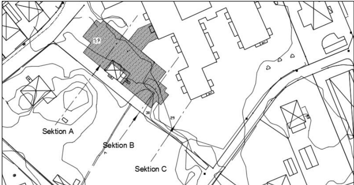
Figur 10-8 – Beräknade stabilitetssektioner benämnda Sektion A–C (ÅF, 2017).
