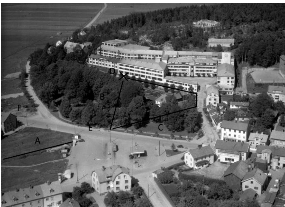
Figur 6. Flygfoto från ca 1948. A = öppet dike som kom från Västra Parken. B = Långt innan ABC-fabriken byggdes gick det ett öppet dike genom parken från en tidigare marknadsplats för kreatur. Om man lade diket i rör eller drog det vid sträckning C är okänt, troligen så har man dragit igenom kyrkogården då det är kortaste vägen. D = Här låg förnicklingsverkstaden med syrabad. E = Befintligt hål i häcken är lika med nuvarande övergångsställe mellan Stadshuset o Parken på metern exakt. F = Plats för den första bensinstationen på busstationen.
