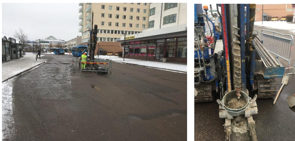
Figur 10. Skruvborrning av provtagningspunkt BH3. Ytlig geologi bestående av sandigt fyller 0-0,5m med underliggande torrskorpelera 0,5-1,0m.
