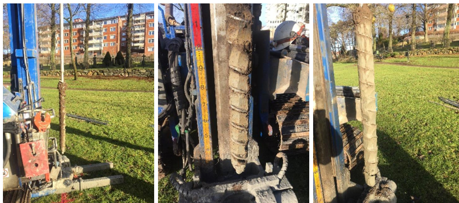
Figur 10. Skruvborring av provtagningspunkt GV2d-Röd. Ytlig geologi bestående av mulligt fyllte 0-0,4m med underliggande torrskorpeleira 0,4-1,0m (bild mitt). Därunder följer lera 1,0-2,0 m (bild höger)
