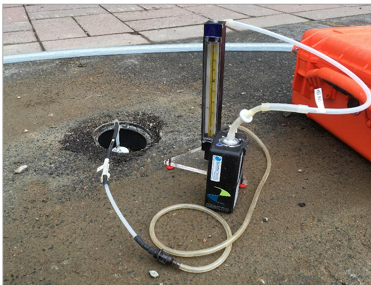
Figur 12. Pumpad gasprovtagning över kolrör med SKC-5000. Kontroll av flödet med rotameter.
