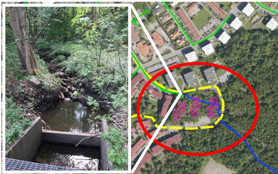
Figur 5. Intagsanordning till kulvertsystem strax söder om Floragatan.
