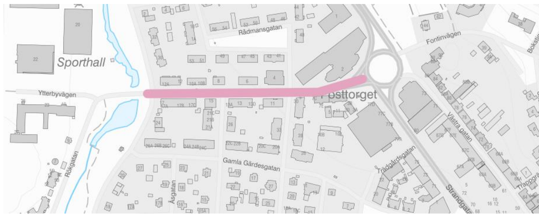
Figur 24. Ungefärligt läge för omläggning av ledning Ytterbyvägen.
