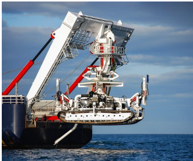
Figur 7. Exempel på mekanisk nedskärningsutrustning.
