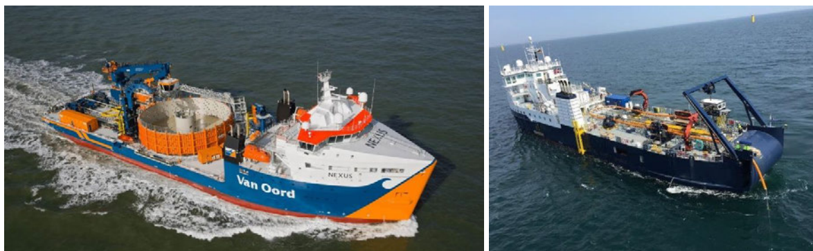
Figur 4. Exempel på kabellägningsfartyg.
